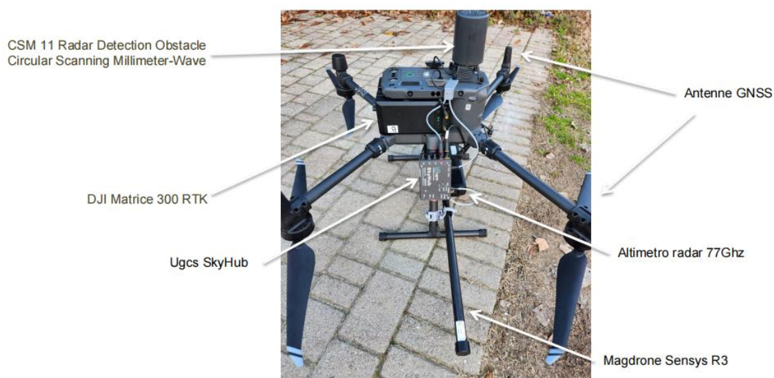
Immagine 52 - Magnetometro MagDrone R3
